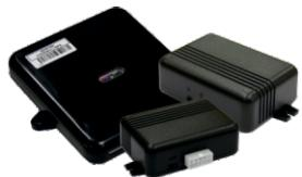
Терминалы ADM позволяют осуществлять контроль ключевых показателей работы техники, выполнять сбор данных CAN-шины и доп. оборудования (RFID-считывателей, датчиков топлива и др.) и передавать информацию в Центр Мониторинга для ее анализа.
